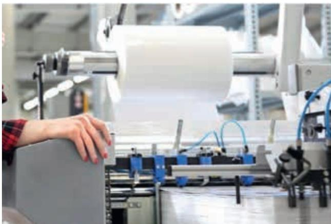
Le film de **pelliculage à froid** est en polypropylène bi-orienté avec un traitement Corona®. La liaison du papier ou du carton est effectuée à l'aide d'une colle humide.
