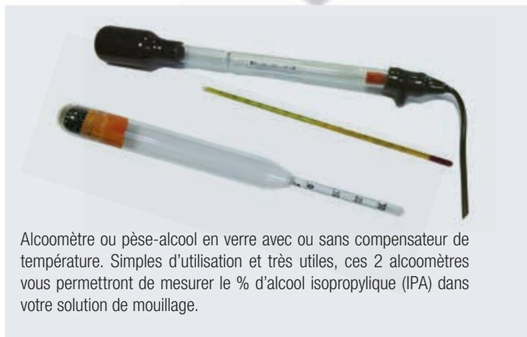
Alcoomètre ou pèse-alcool en verre avec ou sans compensateur de température. Simples d'utilisation et très utiles, ces 2 alcoomètres vous permettront de mesurer le % d'alcool isopropylique (IPA) dans votre solution de mouillage.
